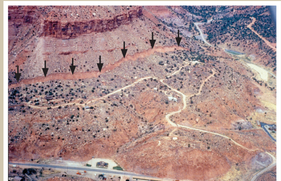
Vista aérea del deslizamiento de tierra de Springdale, provocado por el terremoto de St. George del 2 de septiembre de 1992, M 5.5 . La parte superior del deslizamiento de tierra se denota con flechas negras. Foto cortesía del Servicio Geológico de Utah.
